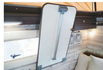
テーブル跳ね上げ式に変更 テーブルが跳ね上げて固定できるタイプに変更となります。すぐ横になりたい時や車内で移動する際に便利です。
