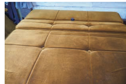
シート展開ワンアクション仕様 ベッド展開が更にスムーズとなったワンアクション仕様になります。標準は背もたれマットを引き抜きますが、Kパッケージでは座面を引き出すだけでベッドとなります。
