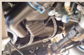
床下排水タンク 車両下部に排水タンク(12L)を設置。給水タンクが13L×2に変更となりますので、長旅でも安心です。
