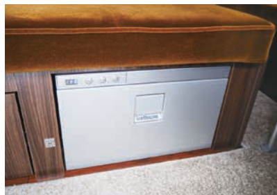
引出し式冷蔵庫に変更 標準の上開き冷蔵庫(14L)が、引出し式冷蔵庫(16L)に変更となります。横向きシート下に収納され見た目もスマートです。
