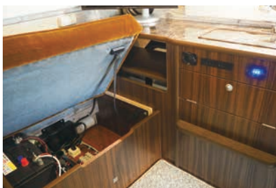
家具レイアウト変更(キッチン廻りフラット加工) 標準では横向きシート下に収納されていた電装類が前向きシート下に変更となります。またキッチン廻りはフラット加工に変更となります。
